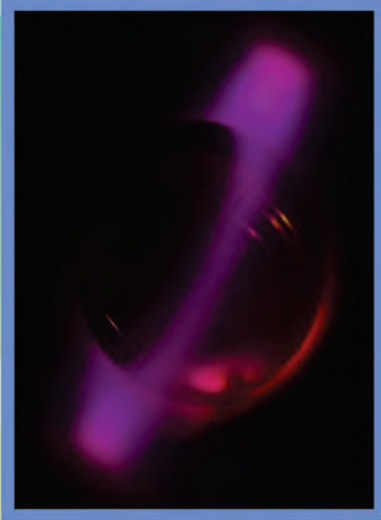
आइपीआर आउटरीच प्रभाग द्वारा विकसित टेरेला डिवाइस की प्रारंभिक छवियां। ( बाएं ) एक ओर का चित्र ( दाएं ) चुंबक के साथ हॉलो स्फियर की भूमध्य रेखा के चारों ओर रिंग करंट का ऊपरी दृश्य Preliminary images of the Terrella Device developed by IPR Outreach Division. (L) Side View (R) Top View of the ring current around the equatorial line of a hollow sphere with a magnet
